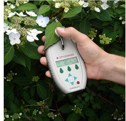
चित्र ५: पात रङ्ग चार्ट (Leaf Colour Chart, LCC) र क्लोरोफिल मिटर (दायाँ)
